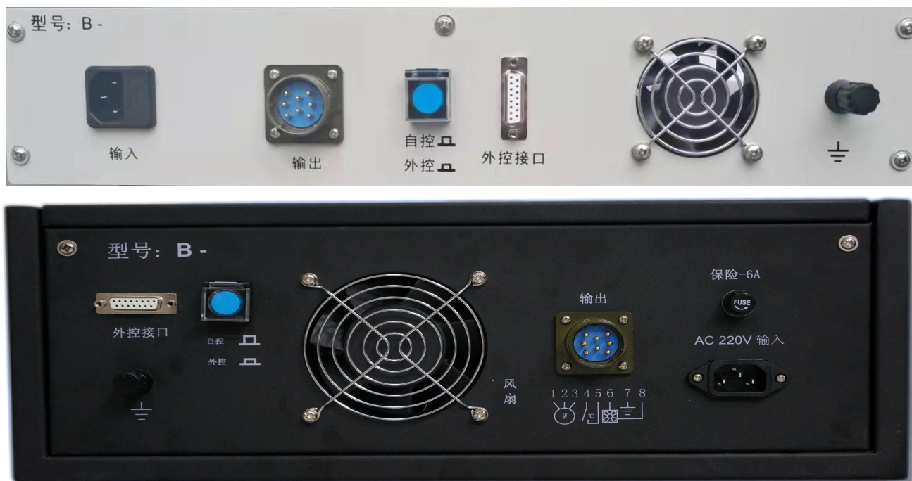
B-600/1200/1600 分子泵电源后面板接口示意图
