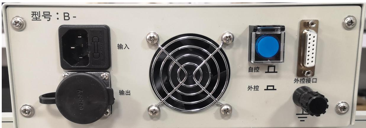
B-300Z 分子泵电源后面板接口示意图
