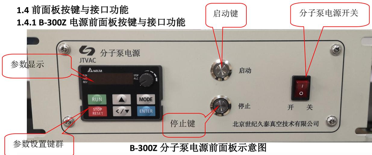
B-300Z 分子泵电源前面板示意图
